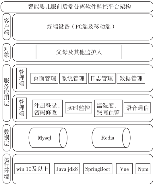
图 7 智能婴儿服软件监控平台系统架构
