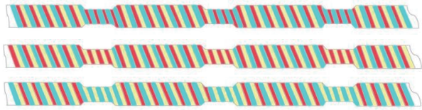
图6 采用2根主体粗纱和1根辅助粗纱纺制形成的细节段彩竹节纱及其花型效果
