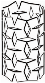
图 12 可降解负泊松比形状记忆聚合物的血管支架
