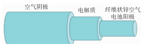
图 2 纤维状锌空气电池组装示意
