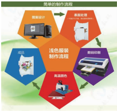
图 3 浅色服装二维码制作流程
