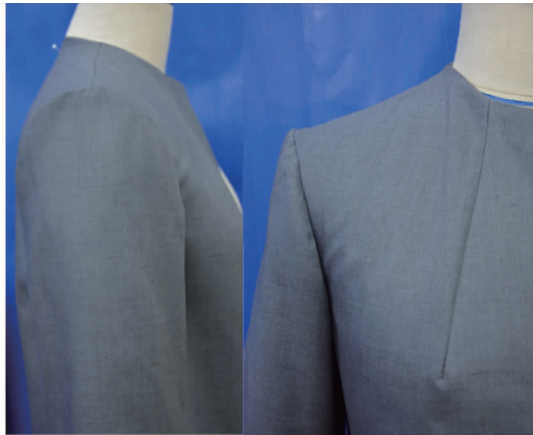
图 6 缩缝量 8% 中等厚度面料肩袖造型
