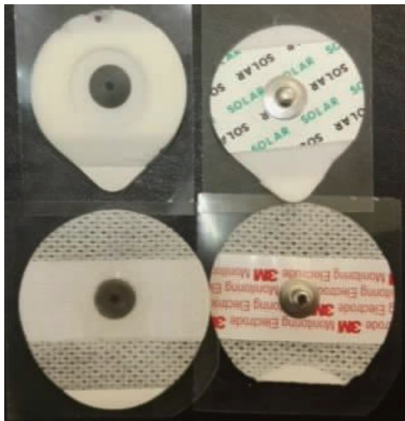
图1 Ag/AgCl 电极及其复合导电凝胶的织物电极
