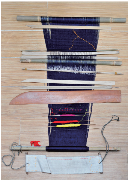
图 1 黎族的踞腰织机 Fig.1 Waist loom of Li brocade
